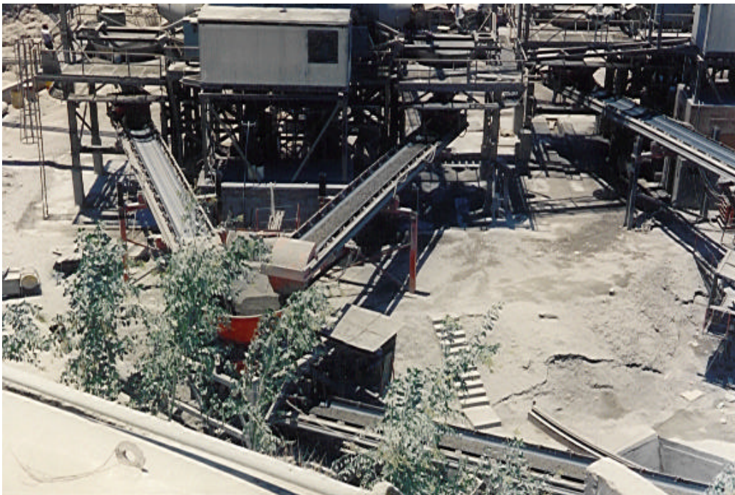
Figura 37- Britador de Impacto- RochaxRocha- para a produção de areia artificial e finos
