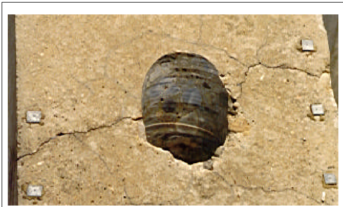
FIGURA 15- ASPECTO INTERIOR DO BLOCO 09, APÓS EXTRAÇÃO DE TESTEMUNHO PARA ANÁLISE PETROGRÁFICA.
