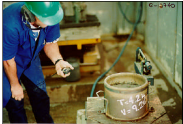
Figura 01- Recipiente de acrílico para ensaio de consistência VeBe.
