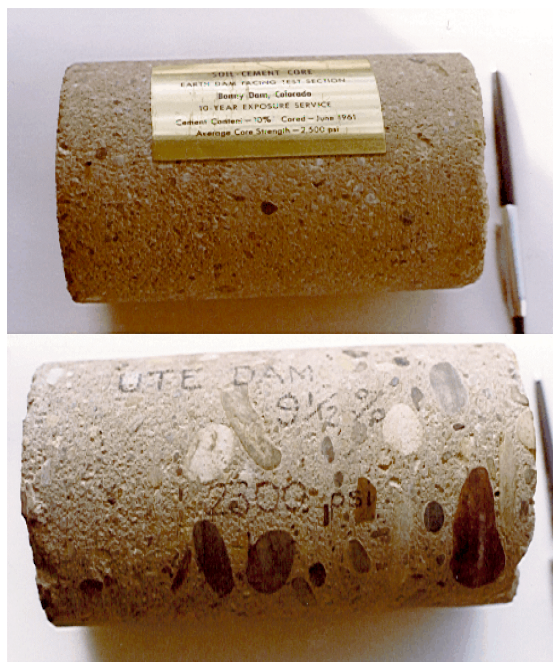
Figura 19- Solo Cimento utilizado como proteção de talude em barragens nos Estados Unidos- Resistência superior a 170 Kg/cm 2 .
