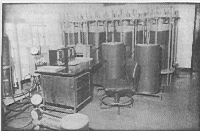
FIGURA 37 - Sala de ensaio de fluência, onde pode se observar os corpos de prova sob carga (à direita, concreto massa convencional e, à esquerda, concreto rolado).
