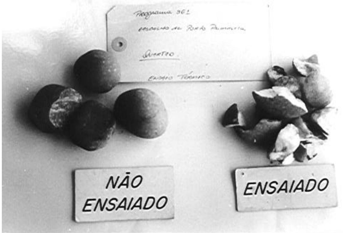
Figura 04- Ensaio Térmico- Ossipov- Material Deletério.
