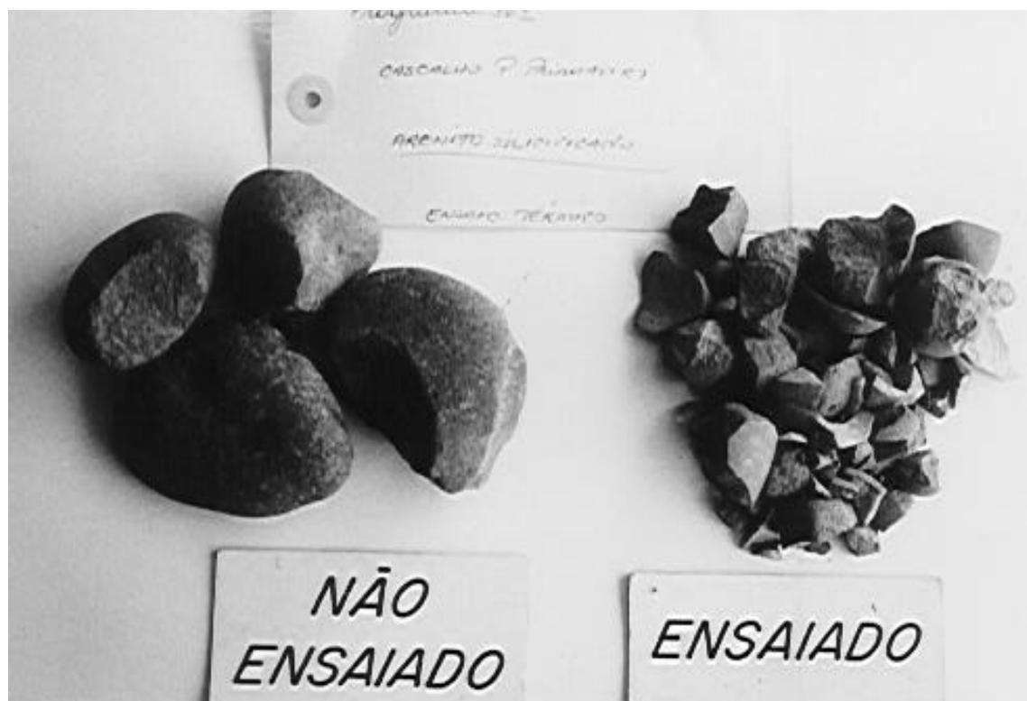
Figura 02- Ensaio Térmico- Ossipov- Material Deletério.
