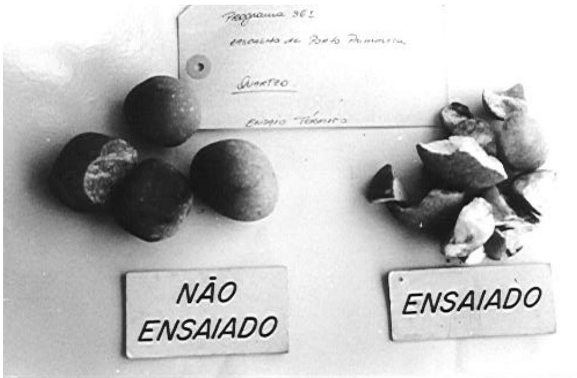
Figura 03- Ensaio Térmico- Ossipov- Material Deletério.
