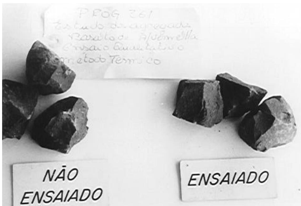
**Figura 06- Ensaio Térmico- Ossipov- Material que deve ser submetido a outro ensaio.**
