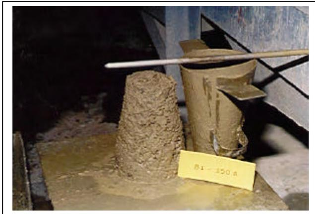
**Concreto com trabalhabilidade (slump) ao redor de 6cm e péssima consistência, com apreciável segregação-exsudação, devido a ausência de finos.**
