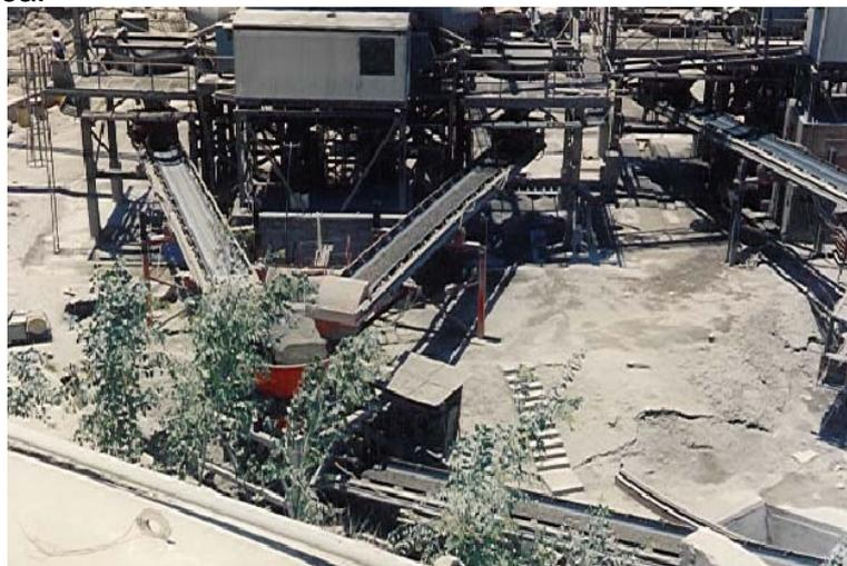
**Figura 34- Centrales de Hormigón del tipo “low-profile” de gran movilidad, y montaje rápido**
