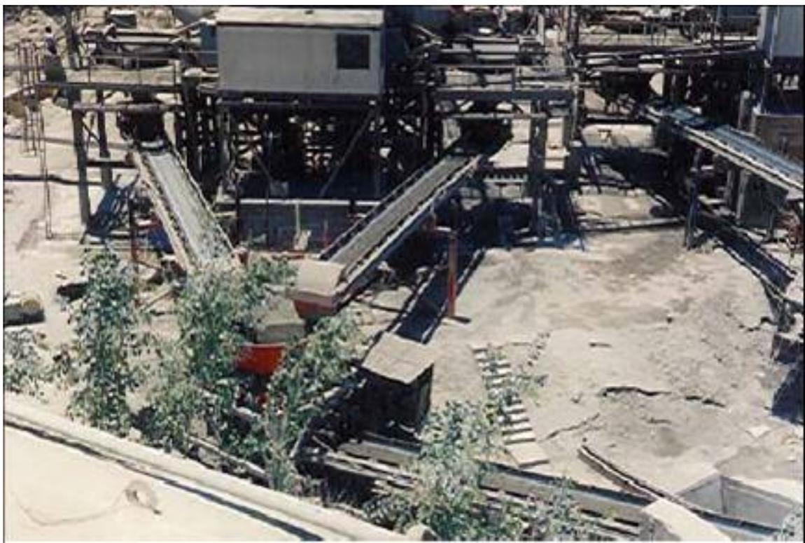
**Figura 34- Centrais de Concreto do tipo “low-profile” com grande facilidade de instalação e locomoção**
